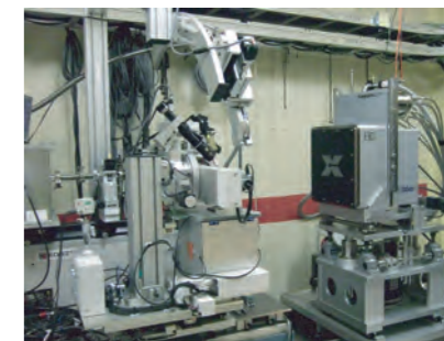
図1: SPring-8の生体超分子構造解析ビームライン
