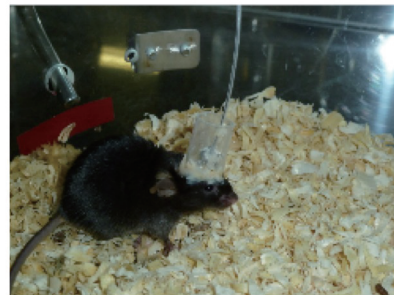
図: ファイバーフォトメトリ法により、行動下のマウスの特定神経細胞の活動を観察する
