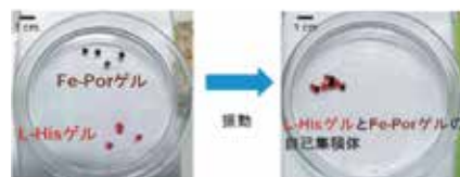
(図3)鉄ポルフィリンゲル(黒褐色)とL-ヒスチジンゲル(赤色染色)との自己集積体形成
