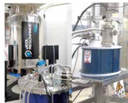
図2 超高感度DNP-NMR装置。極低温でNMRを観測する超伝導マグネット(左)とテラヘルツ波光源であるジャイロトロン(右)
