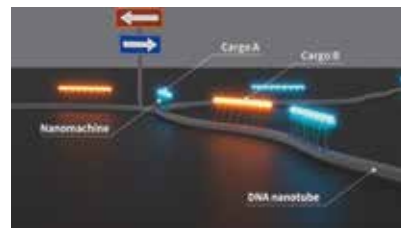
図2. Y字型のDNAナノチューブ上で二種類のナノマシンが「荷物」を仕分けている様子を描いた模式図(Ibusuki et al., Science 2022)。
